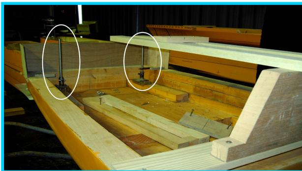
b. Barres avec extensomètres
